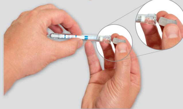
3. Stecken Sie die Verdünnungslösung **C** in den Testständer **G** und drücken Sie sie mit dem Finger nach unten.
